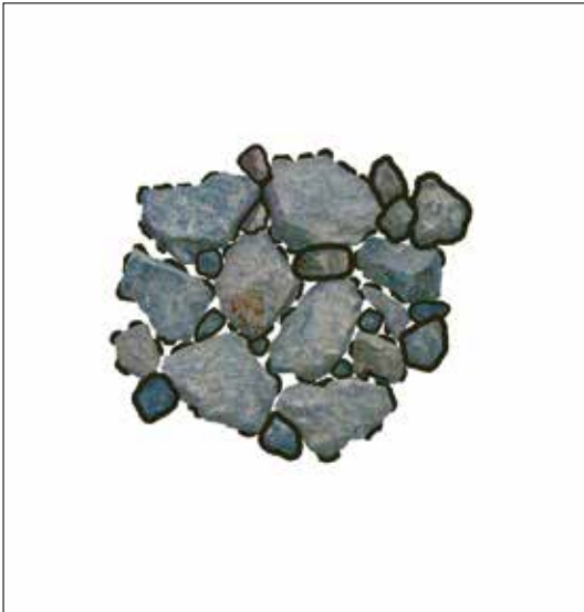
Bild 15: Schaumbitumen-Verteilung (schwarze Flecken)/ Unterbrochene Verbindungen („punktverschweiß“)
