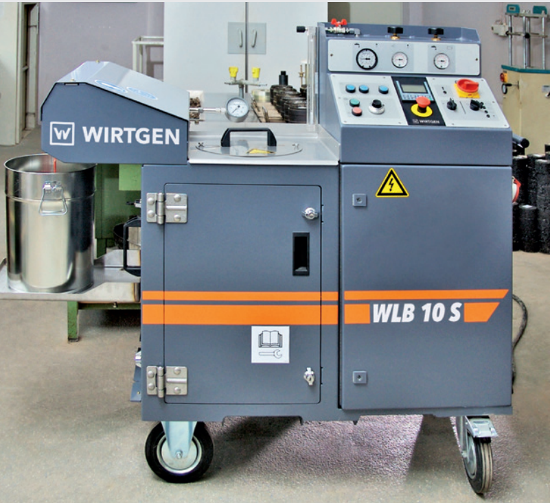
Abbildung 6: Laboranlage zur Herstellung von Schaumbitumen
