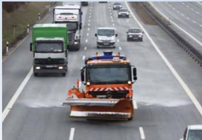
Bild 4: Vorbeugende Streuung mit Salzlösung (Quelle: Bayerische Straßenbauverwaltung)
