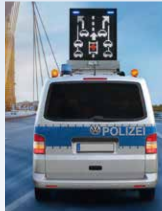
Die LED-Anzeige des WeNiPol III ermöglicht die dynamische Darstellung beliebiger Zeichen und Texte
